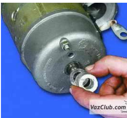
12. ...а затем регулировочные шайбы.
