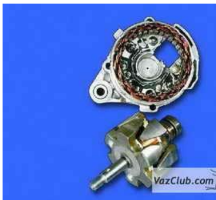
14. Выньте якорь из крышки со стороны коллектора.
