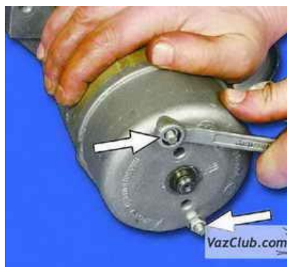
13. Отверните гайки стяжных шпилек.
