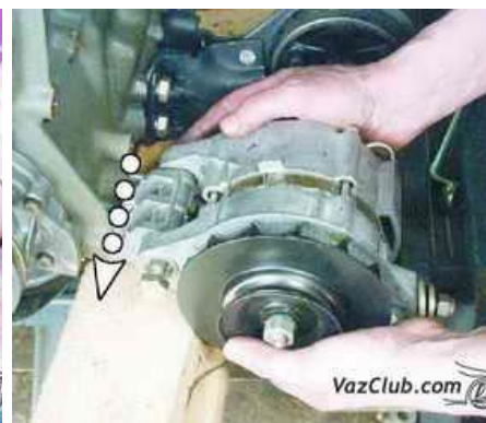
30. Выньте болт, придерживая генератор, и снимите его с двигателя.
