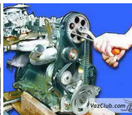
30. Выньте болт, придерживая генератор, и снимите его с двигателя.
