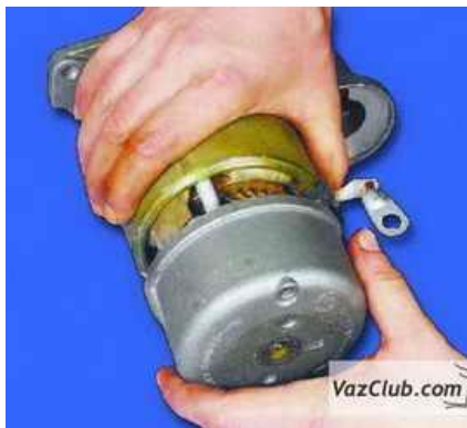
14. Снимите крышку со стороны коллектора.
