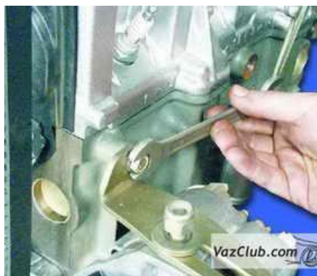
28. Отверните болт крепления натяжной планки к блоку цилиндров.
