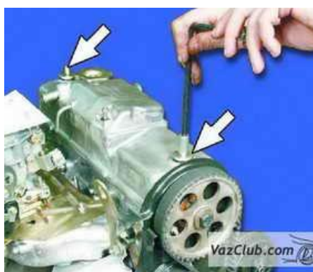
28. Отверните болт крепления натяжной планки к блоку цилиндров.
