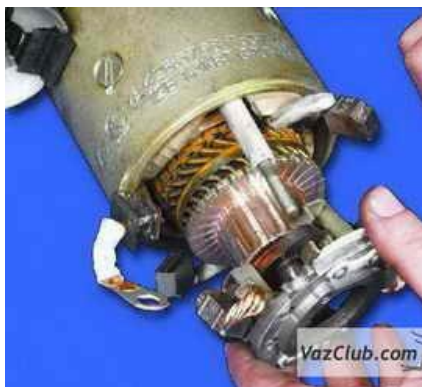
16. Снимите щеткодержатель (см. примечание).
