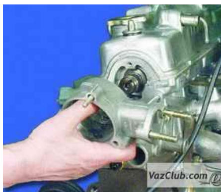
22. Снимите корпус привода распределителя зажигания (вспомогательных агрегатов).
