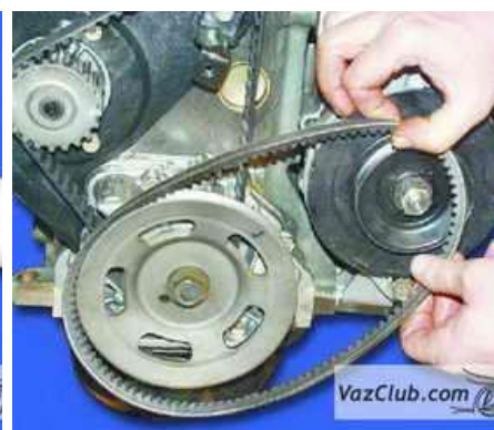
27. Снимите ремень привода генератора.
