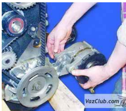
29. Полностью отверните гайку крепления генератора.
