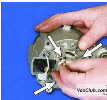
16. Выньте три болта крепления выпрямительного блока и выводов статора с изолирующими колодками.
