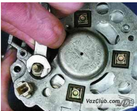
18. Отверните гайку крепления клеммы “30”.
