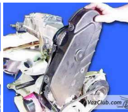
24. Снимите переднюю крышку.
