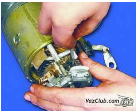
15. Отожмите отверткой пружины обеих изолированных щеток и выньте щетки из щеткодержателя ваз 2109.
