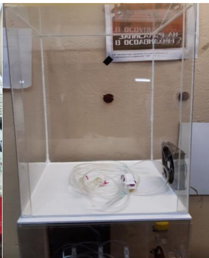
Фотография 1 (а-в) – Создание корпуса теплицы из полиэтиленового стекла с вентилятором
