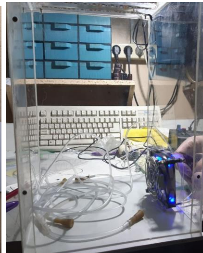
Фотография 1 (а-в) – Создание корпуса теплицы из полиэтиленового стекла с вентилятором
