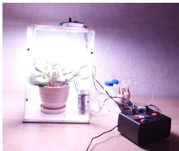
Фотография 3 - Разработка устройства управления освещением: а - при дневном освещении; б - использование белого света; в-г - использование красно – синего спектра света
