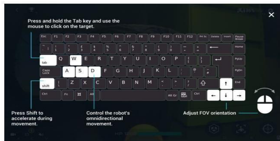
Схема использования клавиш компьютера на ОС Windows для управления RoboMaster S1
