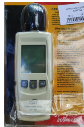
Рисунок 5. Измерение уровня шума. Слева — процесс, справа - цифровой шумометр GM1352.
