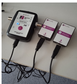
Рисунок 6. Измерение содержания угарного газа и кислорода.
