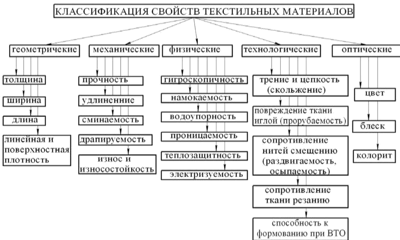
Рис. 18. Классификация свойств текстильных материалов
