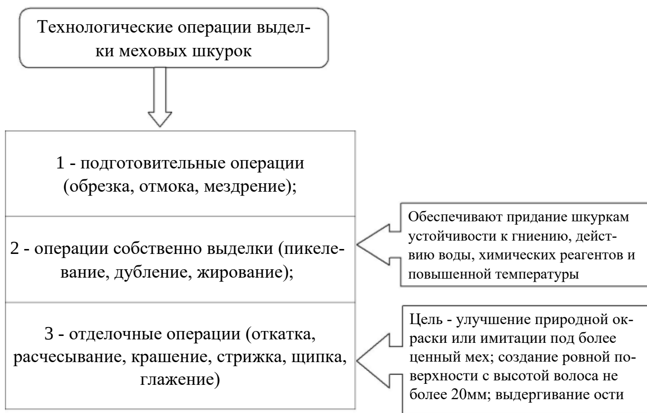
Рис. 21. Технологические операции выделки меховых шкурок
