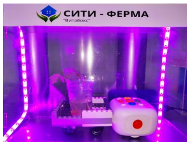
Свето-бокс. Ночное освещение осуществляют фитолампы с датчиком включения
