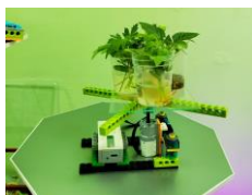
Робот-карусель позволяет вращать контейнеры с растениями для равномерного распределения света
