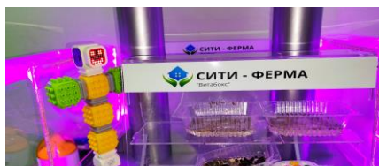
Робот-контролер эмоциями на электронном табло сообщает о состоянии микроклимата на сити-ферме
