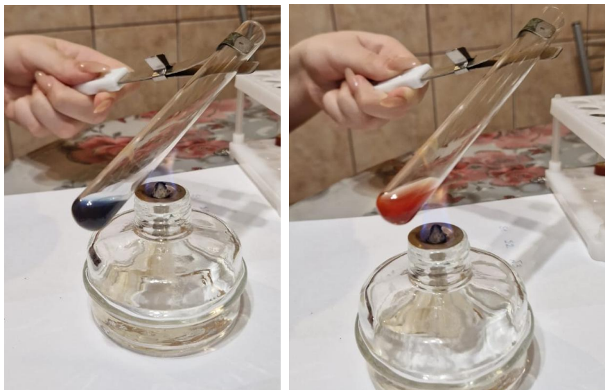
Рис. 11. Образец мёда после прибавления реактивов до термической обработки (слева), образец после термической обработки (справа)
