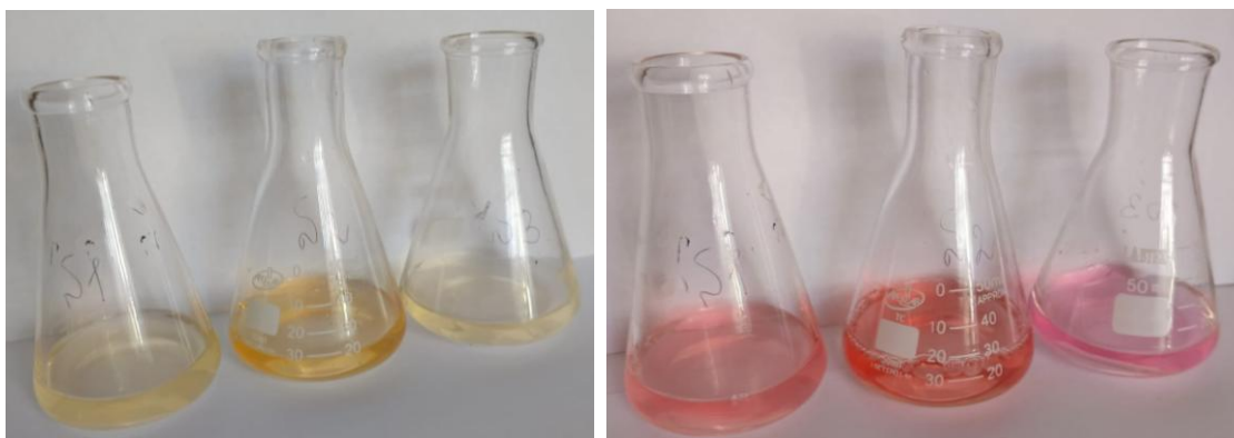
Рис. 17. Образцы мёда подготовленные к титрованию (слева), оттитрованные образцы мёда (справа)
