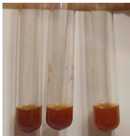
Рис. 12. Образование желто-красного осадка (закись меди) в образцах мёда
