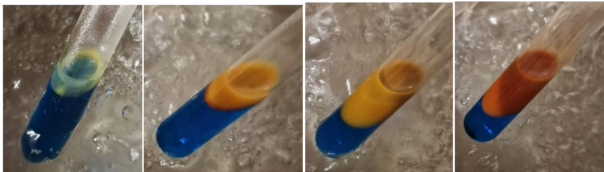
Рис.13. Процесс термической обработки образца мёда в кипящей водяной бане
