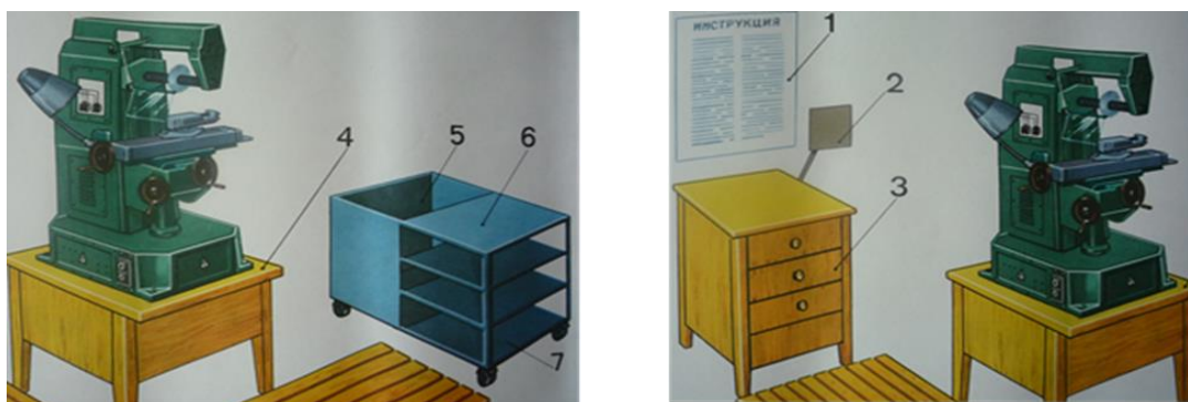
Фото 3. Типовой проект рабочего места для фрезерных работ.
