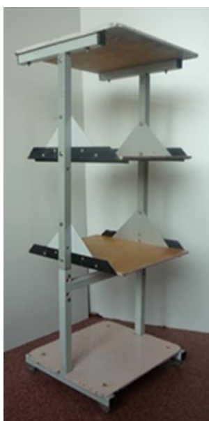
Фото 11. Проектируемый вариант организационной оснастки на основе конструктивных элементов ученических стульев.
