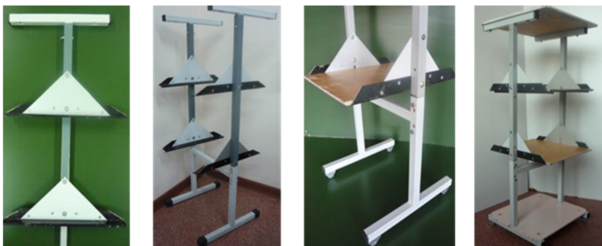
Фото 21. Выполнение разъемных соединений сборочных узлов.
