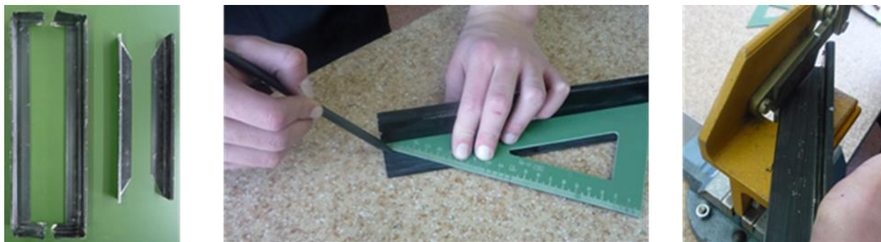
Фото 15. Подготовка деталей кронштейна для полочек.
