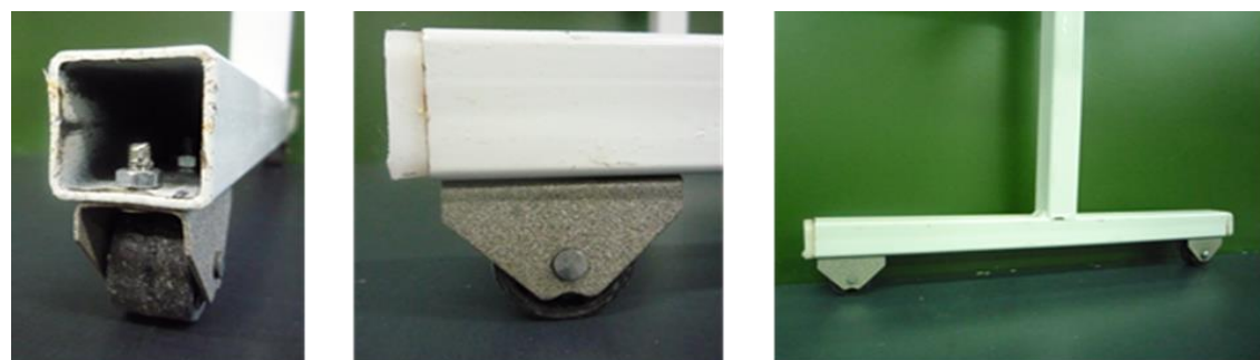
Фото 20. Установка мебельных роликов.
