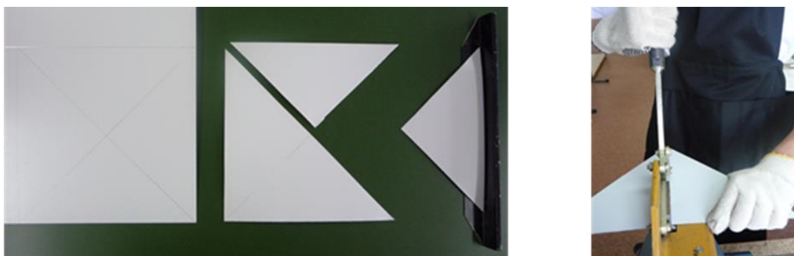
Фото 16. Подготовка деталей кронштейна для полочек.
