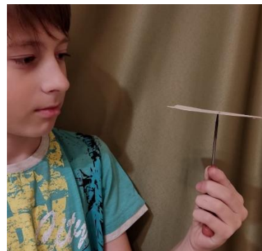
Демонстрация к эксперименту № 1. Подтверждение способа определения центра тяжести плоских фигур
