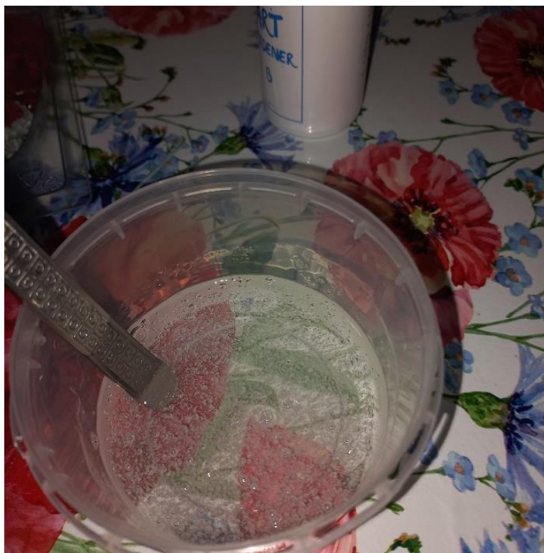
Рис. 1.3. Замешивание состава эпоксидной смолы
