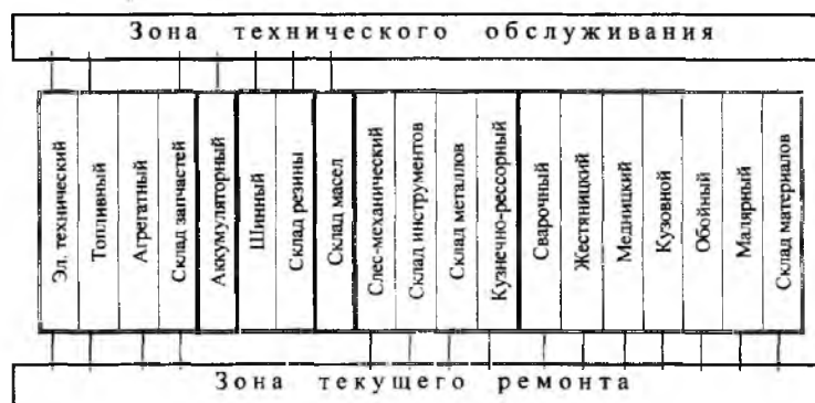
Рис. 1. Группировка цехов и их связи с производственными зонами.
