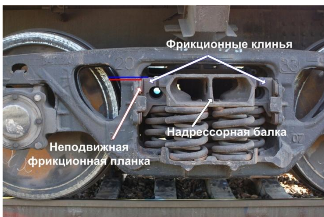
Рисунок 2. Определение загрузки вагона по уровню клина относительно планки на боковинах тележки а)- нагрузка на ось менее 3т; б)- нагрузка на ось более 6т
