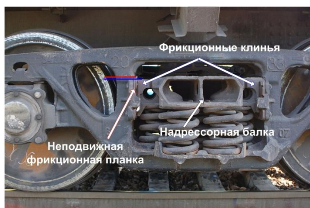
Рисунок 2. Определение загрузки вагона по уровню клина относительно планки на боковинах тележки а)- нагрузка на ось менее 3т; б)- нагрузка на ось более 6т
