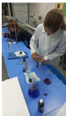
Рисунок 6 – исследование адсорбционной емкости по метиленовому голубому.
