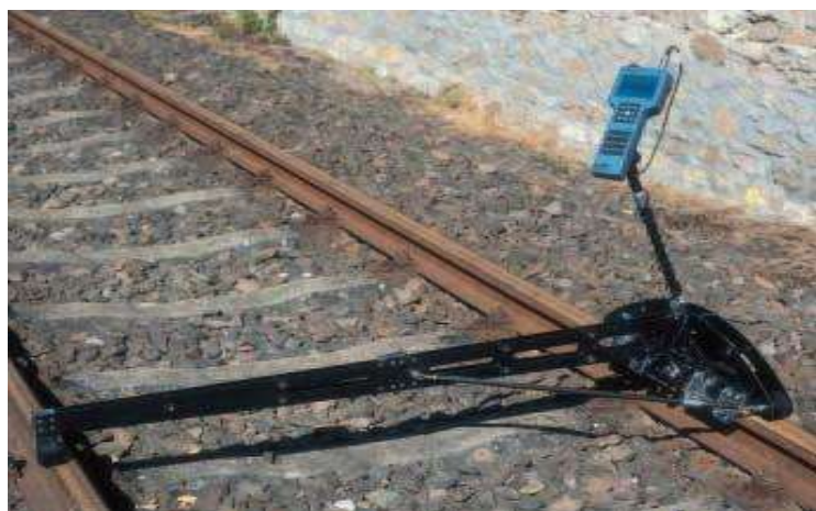
Рис. 4.25. Тележка для ручной диагностики Draisine Light (Draisine + прибор ELOTEST M2V3) (Германия)
