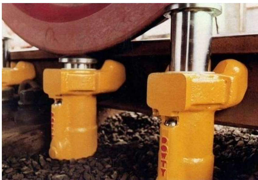
Рис. 3.22. Внешний вид точечного вагонного замедлителя КХ-НТВ-1 (Китай)
