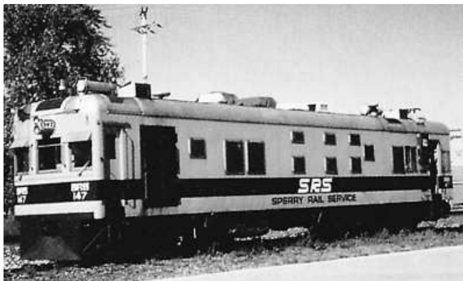
Рис. 4.26. Вагон-дефектоскоп на железных дорогах США
