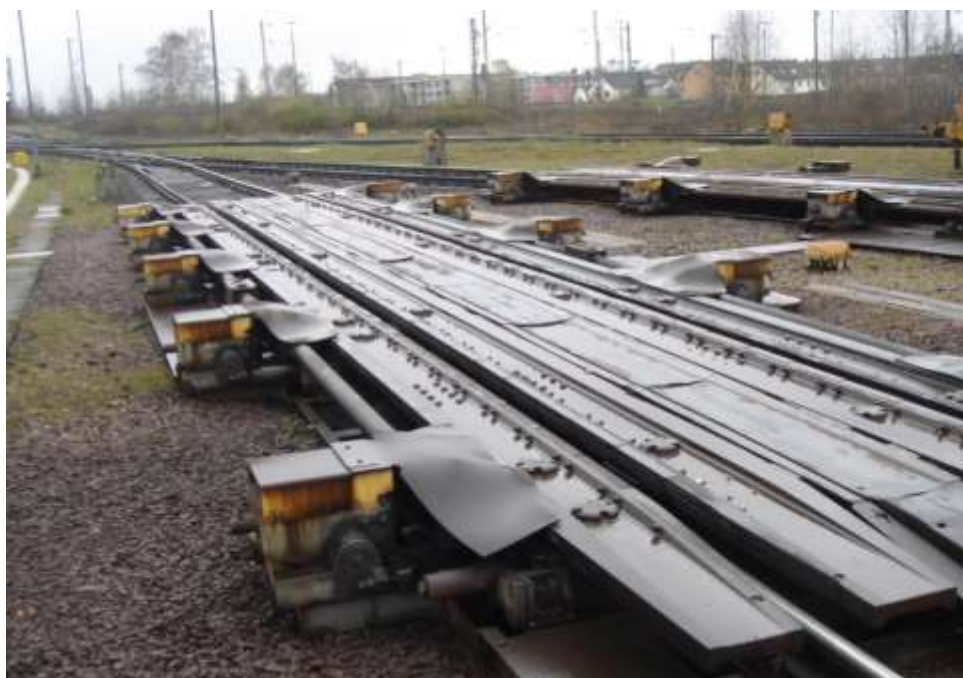
Рис. 3.16. Внешний вид вагонного двухрельсового гидравлического замедлителя фирмы Тиссен (Германия)
