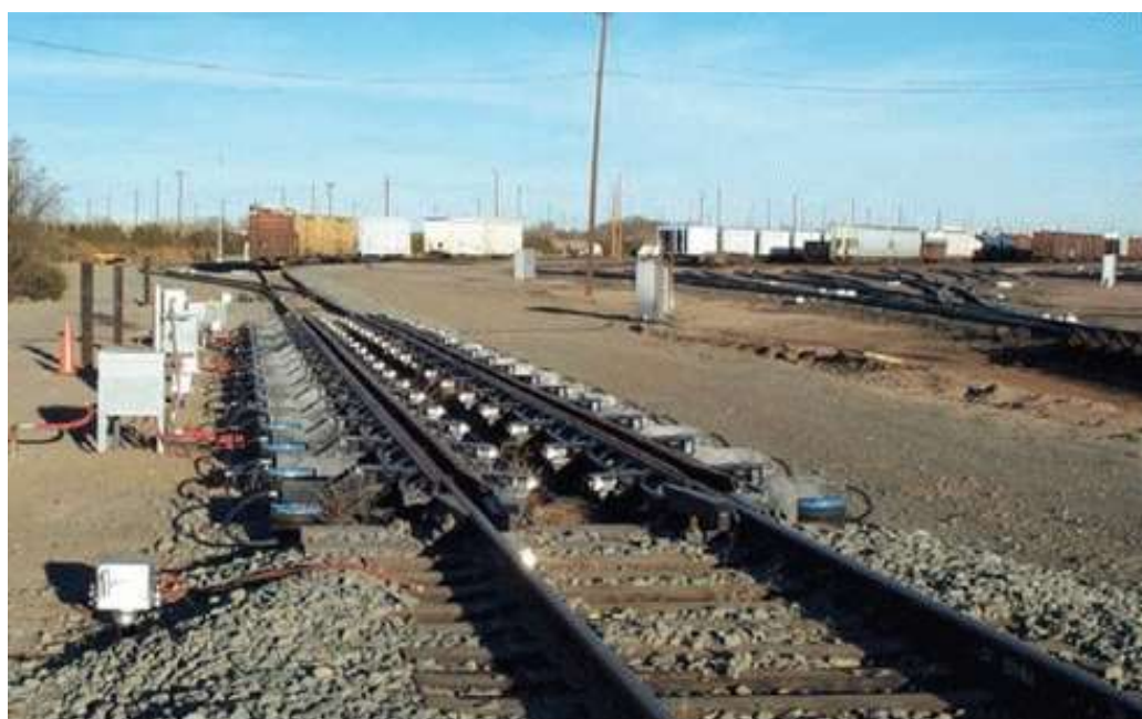
Рис. 3.18. Внешний вид нажимного вагонного замедлителя типа SR 2000 (США)
