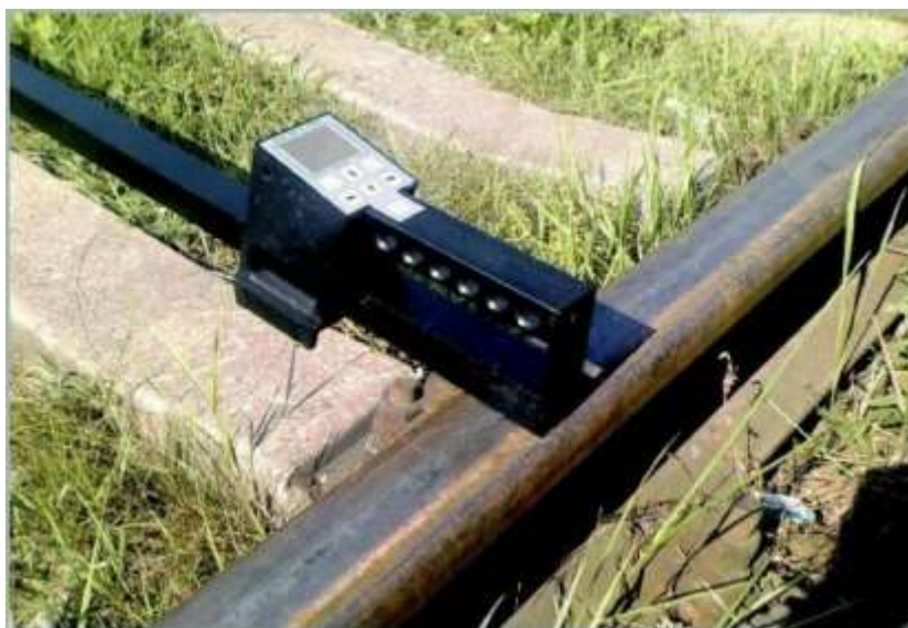
Рис. 4.23. Электронный шаблон ШЭП-1П
