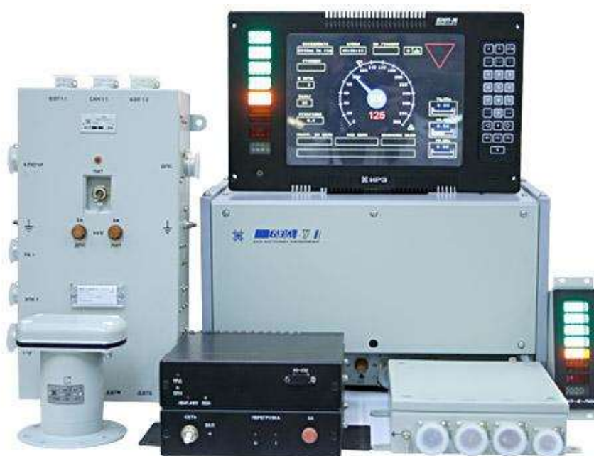
Рис. 7.1. Общий вид конструкции КЛУБ-У
