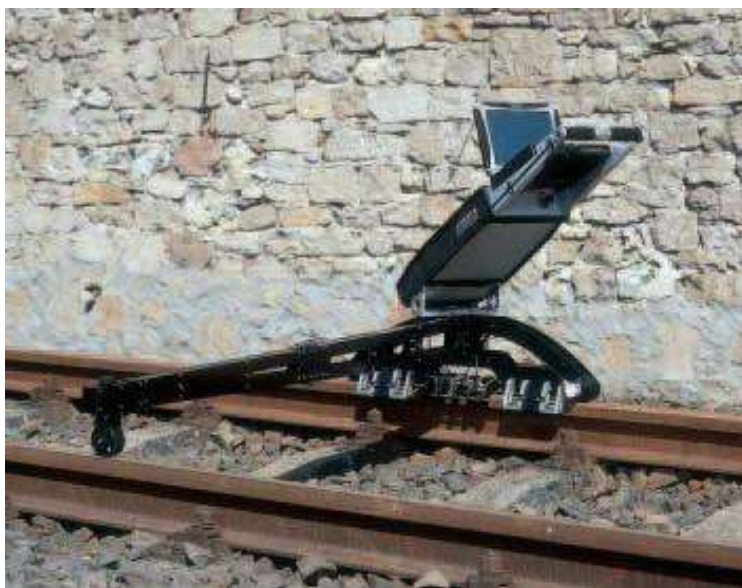
Рис. 4.24. Тележка для ручной диагностики Draisine 300 (Германия)
