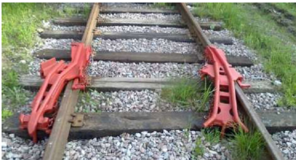
Рис. 2.15. Накаточный башмак «рыбка»
