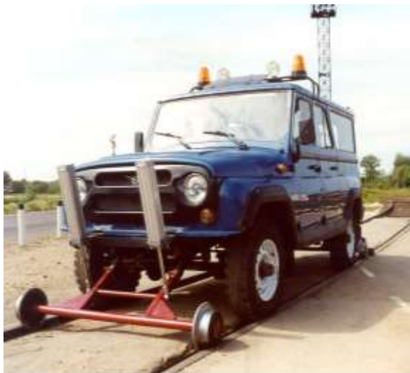
Рис. 4.29. Автомобиль-дефектоскоп на базе автомобиля УАЗ
