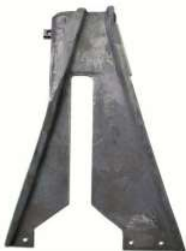
Рис. 2.14. Титановый накаточный башмак «лягушка»
