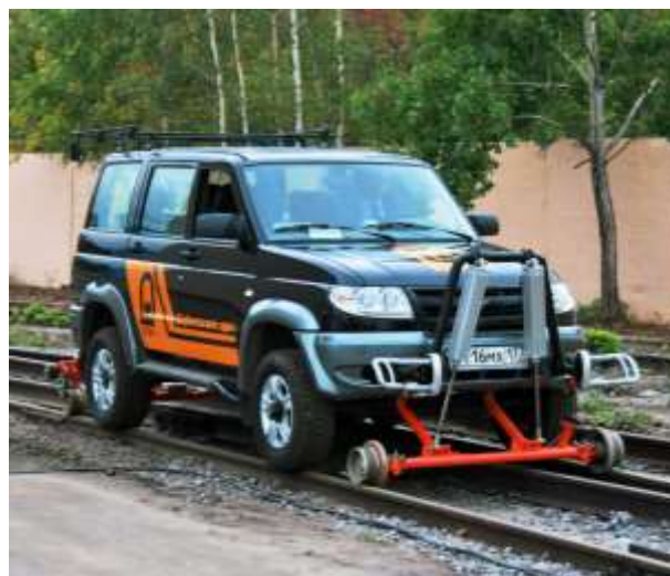
Рис. 4.30. Автомобиль-дефектоскоп на базе автомобиля УАЗ Патриот
