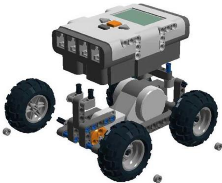
Рис. 8. Для надежности колеса закрепляются втулками.
